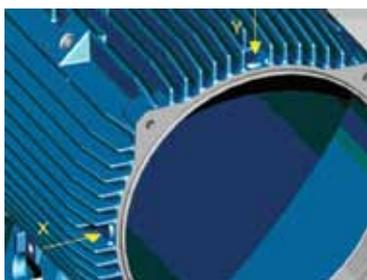
Figura 6 - Áreas planas para la verificación de vibraciones en la parte trasera de la carcasa
